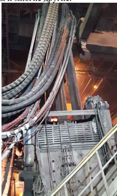
Рис. 4. Обвязка плавильной индукционной печи водоохлаждаемыми рукавами, оснащенными резиновыми спиральными биндажами Fig. 4. Binding of the melting induction furnace with water-cooled sleeves equipped with rubber spiral bandages
