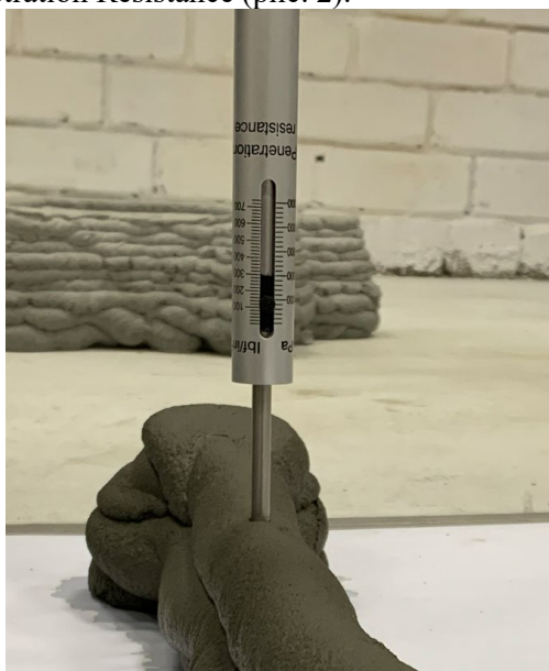
Рис. 2. Определение кинетики набора прочности пенетрометрическим методом Fig. 2. Determination of the kinetics of strength gain by the penetrometric method
