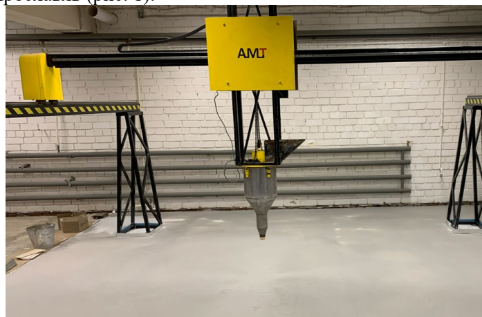
Рис. 1. Строительный 3D-принтер марки «АМТ S-6044» в лаборатории аддитивных технологий строительного производства КГАСУ
