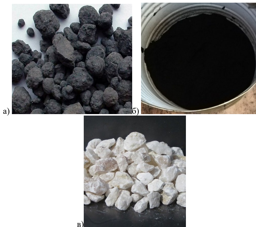
Рис. 2. Компоненты КЦ: а) портландцементный клинкер, б) алюмосиликаты, в) двуводный гипс Fig. 2. CC components: a) Portland cement clinker, б) aluminosilicates, c) dihydrate gypsum
