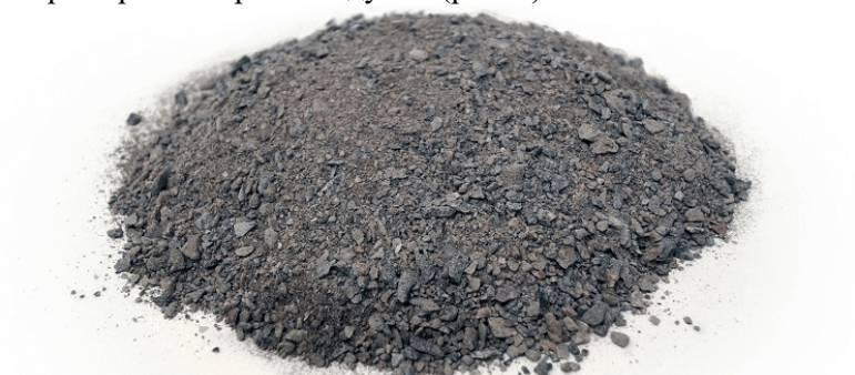
Рис. 3. Внешний вид отсева дробления гранитного щебня Fig. 3. Appearance of granite crushing screening
